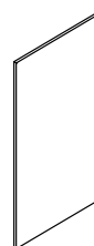
Panel boczny na wysokość 1080 mm Symbol Name Wymiar [SxWxG] Dimension [WxHxD] Panel boczny 304 x 1080 x 19 Panel boczny 304 x 1080 x 16 Panel boczny 320 x 1080 x 19 Panel boczny 317 x 1080 x 16
